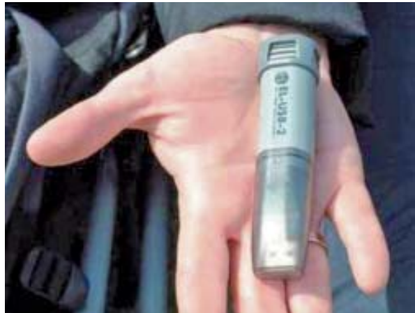
Abb. 4: Datalogger zur Aufzeichnung von lokalen Wetterdaten wie Temperatur, Luftfeuchtigkeit und Taupunkt.
