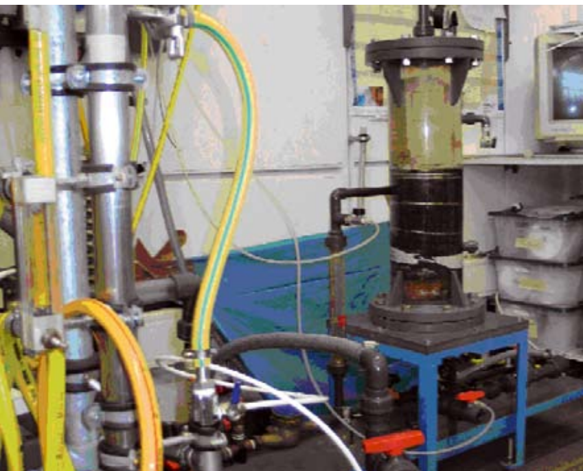
Aufbau der Versuchsanlage mit Membranmodul und PSK-Filter
