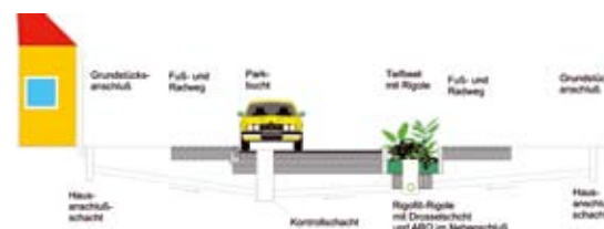
Schematische Darstellung eines Mulden-Rigolen-Systems im Straßenraum
