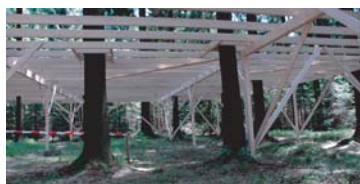
Experiment des Bayreuther Zentrums für Ökologie und Umweltforschung (BayCEER, Universität Bayreuth) zur Dynamik von Bodenprozessen bei extremen meteorologischen Randbedingungen, d.h. Austrocknungs-Wiederbefeuchtungs- und Gefrier-Auftau-Zyklen (DFG Forschergruppe 562).
