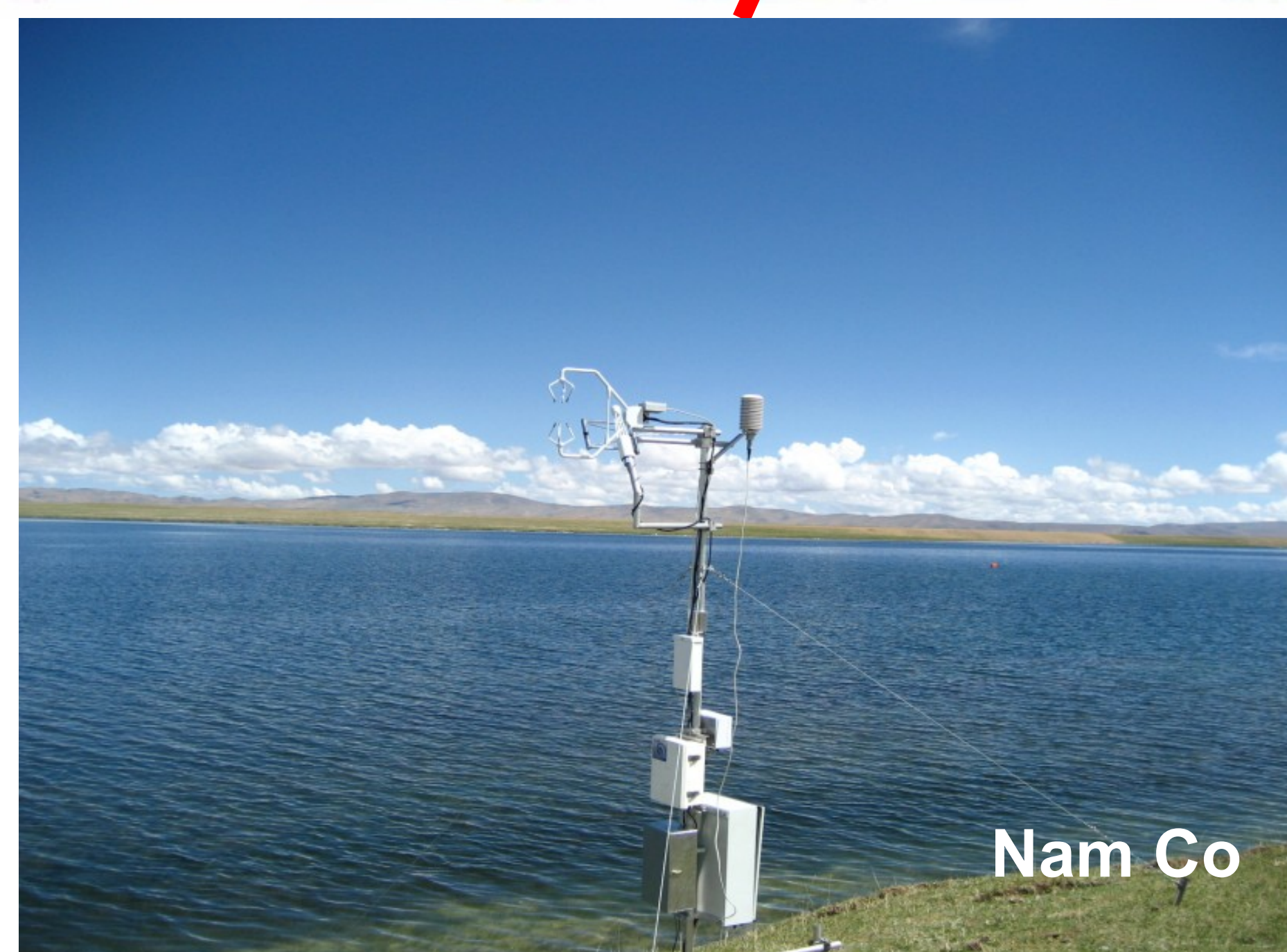
Ergänzend zu den kontinuierlichen Energiebilanzmessungen der Chinesischen Akademie der Wissenschaften (Bild oben) wurden durch die Universität Bayreuth im Sommer 2009 zusätzliche Energieaustauschmessungen am Nam Co See (unten links) und in Kema (unten rechts) durchgeführt. Das erste Experiment diente dazu, Daten über Wasser und Wiese zu messen, um entsprechende Modellierungen zu validieren (s. getrenntes Poster von Thiem et al.). Im zweiten Experiment (2010) wurden zusammen mit Ökologen die Kohlenstoffflüsse über und im Boden von beweideten und unbeweideten Flächen ermittelt.
