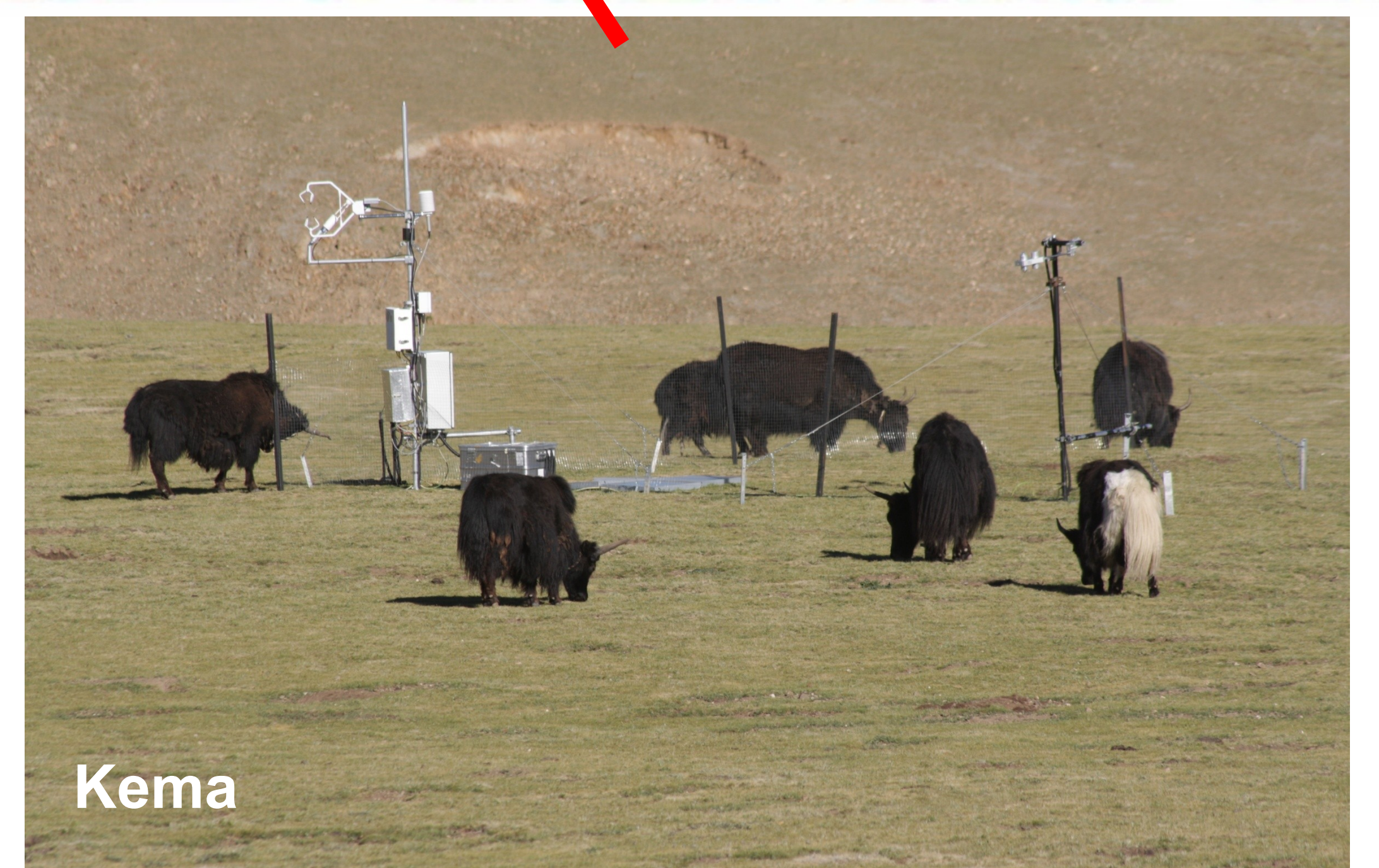
Ergänzend zu den kontinuierlichen Energiebilanzmessungen der Chinesischen Akademie der Wissenschaften (Bild oben) wurden durch die Universität Bayreuth im Sommer 2009 zusätzliche Energieaustauschmessungen am Nam Co See (unten links) und in Kema (unten rechts) durchgeführt. Das erste Experiment diente dazu, Daten über Wasser und Wiese zu messen, um entsprechende Modellierungen zu validieren (s. getrenntes Poster von Thiem et al.). Im zweiten Experiment (2010) wurden zusammen mit Ökologen die Kohlenstoffflüsse über und im Boden von beweideten und unbeweideten Flächen ermittelt.
