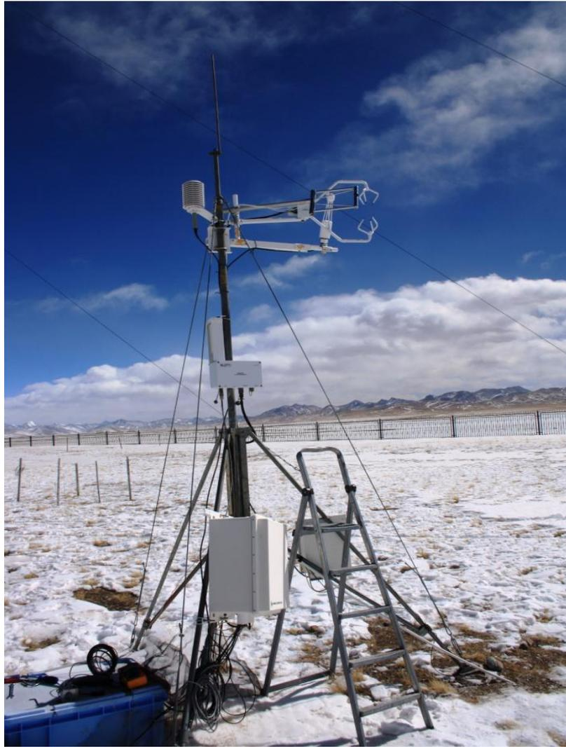
**Abbildung 2.5 Eddy-Kovarianz-Messkomplex der Nam Co Station in Tibet mit Anemometer (C-SAT) und Feuchtesensoren (KH20, LI-7500). (Foto: Tobias Biermann)**
