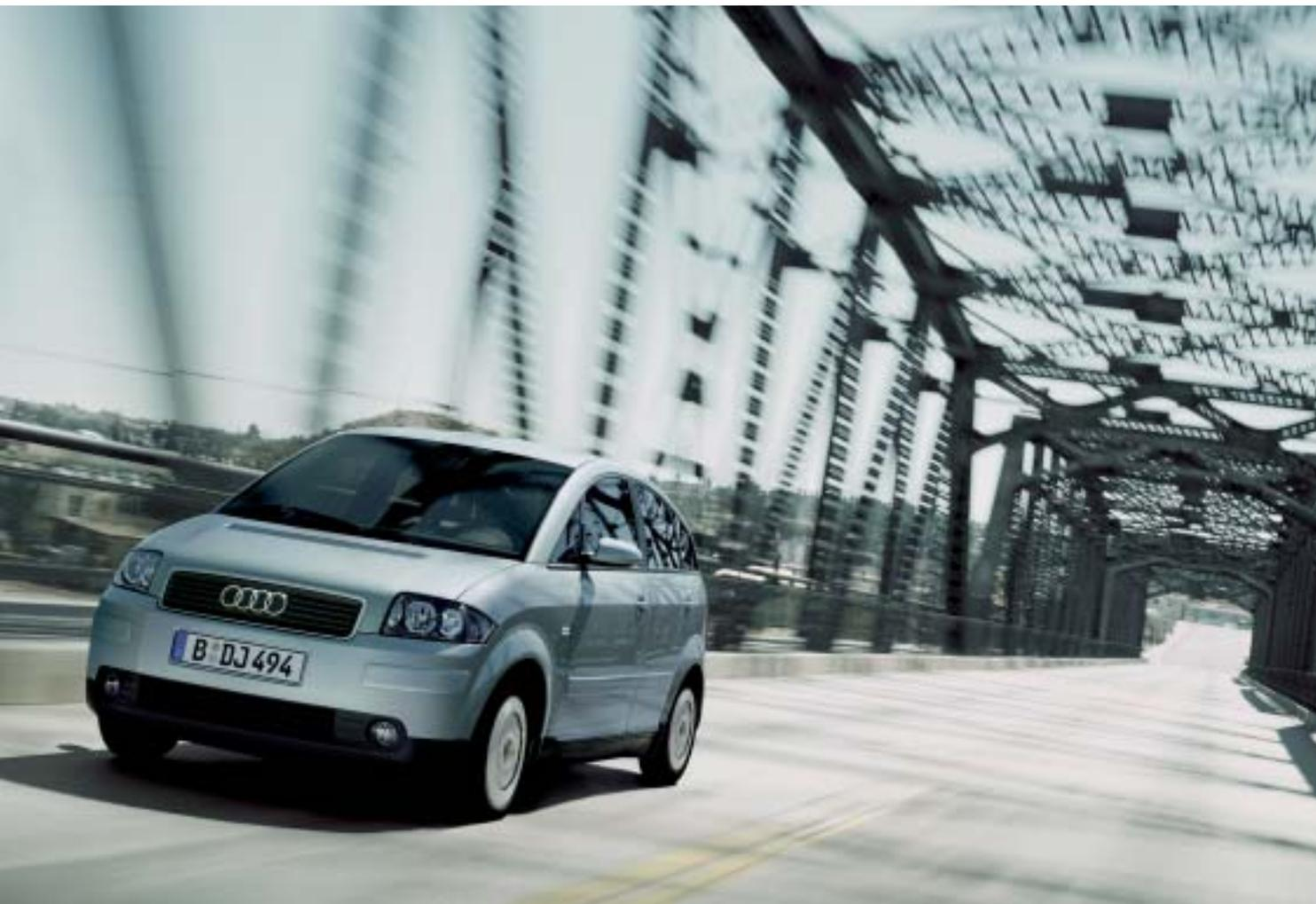
Das Dreiliter-Auto vereint zahlreiche technische Innovationen in sich, wie die TDI-Motorentechologie und die Vollaluminium-Karosserie in Audi Space Frame Bauweise. Hinzu kommt ein extrem niedriger Luftwiderstand mit einem  $c_w$ -Wert von 0,24. Kein anderer Serien-Pkw verfügt derzeit über einen niedrigeren Luftwiderstandsbeiwert (Stand Januar 2005).
