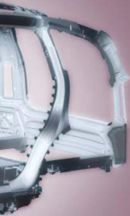
kommt die patentierte Längsträgerkonstruktion, die die Aufprallenergie im Vorbau besonders effektiv auffängt.
