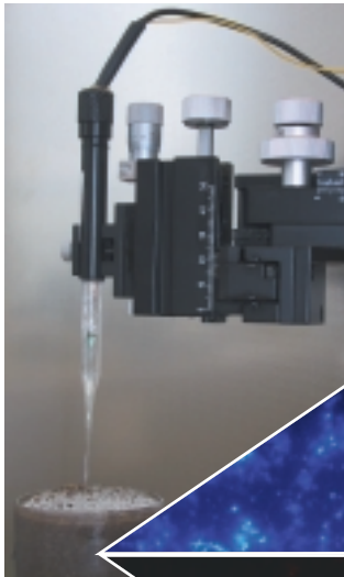
Abb.1: O 2 -Mikrosensor-Messung in einem Sedimentkern
