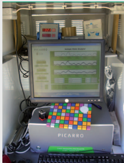
Ein Blick ins Innere des Messcontainers mit laufenden Isotopenanalysen am Laserspektrometer. Foto: C. Werner
