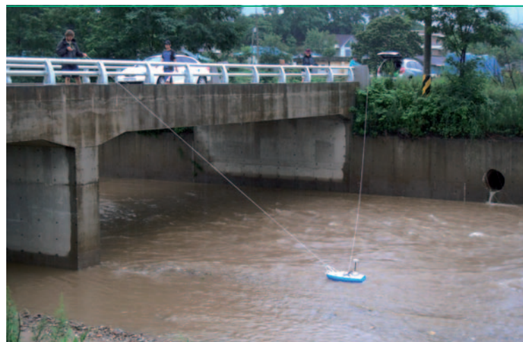
Abb.5: Über die Messung von Strömungsprofilen in Kanälen und Bächen wird die Menge des abfließenden Wassers bestimmt.
