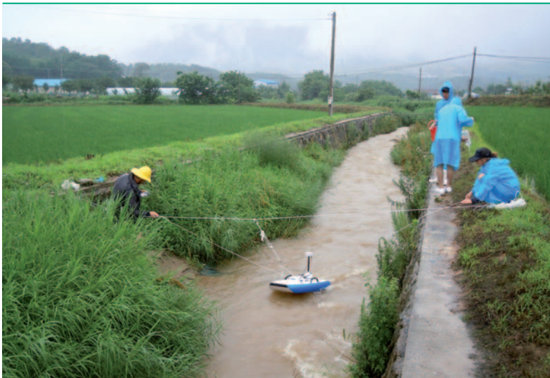
Abb. 4: Messung der Strömungsprofile an einem Kanal im Haean-Becken während der Monsun-Regenzeit.
