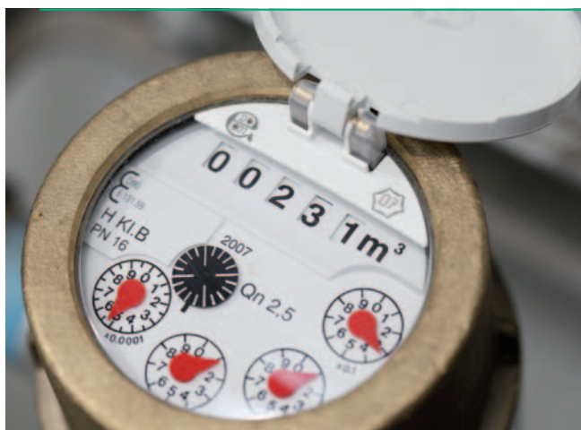
Abb. 3: Wasserzähler zeigen mit Hilfe eines eingebauten Flügelrads das Volumen der durchgeflossenen Wassermenge an. Das Prinzip wurde schon 1851 in England entwickelt. (Foto: sst)
