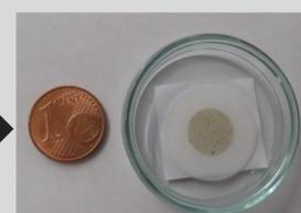
Probe auf Filter nach Extraktion und enzymatisch-oxidativer Aufreinigung
