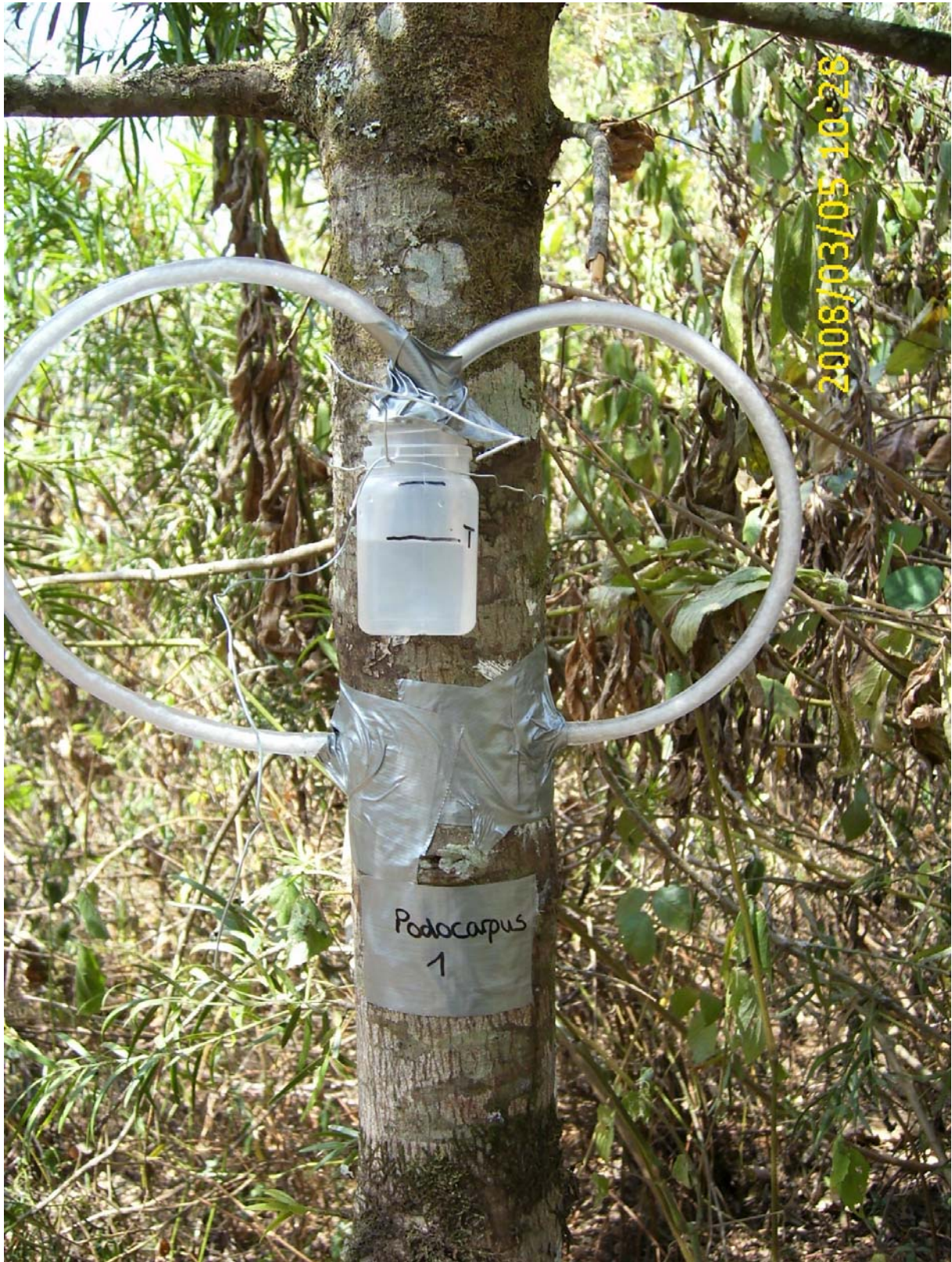
Abb. 3. Anordnung für die in situ 15 N-Stamminjektion.
