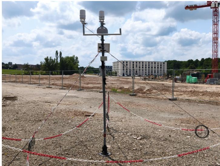
Abbildung A.1.: Aufbau des Instrumentenvergleichs im Juni 2023 der Mikrowetterstation Quartier Kreuzstein (Rechts) und einer weiteren Mikrowetterstationen (Links). Aufgrund von dem geringen Abstand zwischen den beiden Mikrowetterstationen konnte eine gegenseitige Beeinflussung nicht ausgeschlossen werden. Blickrichtung nach Süden.
