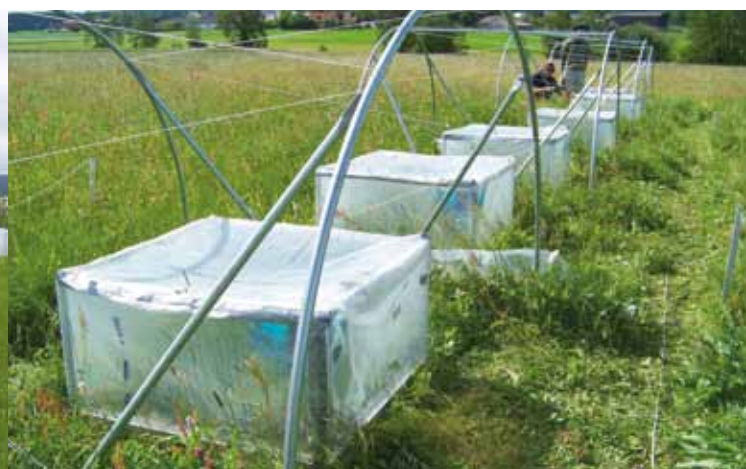
▲ Abbildung 2 In diesen \rightarrow Isotopenmarkierungskammern werden die Pflanzen ca. 2 Stunden einer mit ^{13}\text{CO}_2 angereicherten Atmosphäre ausgesetzt. Diese nehmen den markierten Kohlenstoff durch Photosynthese auf und bringen ihn so in das Ökosystem ein.
