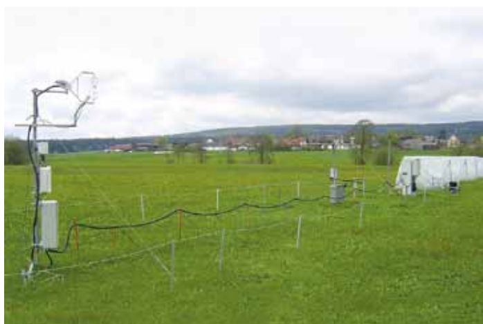
▲ Abbildung 1 Messstation „Voitsumra“ nahe Weißenstadt im Fichtelgebirge im Sommer 2010 links: Messturm zur Bestimmung der Verdunstung und des Kohlendioxidaustausches ( \rightarrow Eddy-Kovarianz-Methode), Mitte: Langzeit-Messstation zur Bestimmung klimatischer Randbedingungen, rechts: Dächer zur Simulation von Dürre
