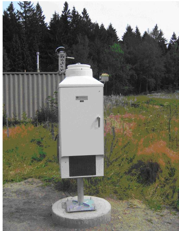
Abb. 2: Niederschlagsmesser mit Probenwechslers zur Bestimmung der nassen Deposition
