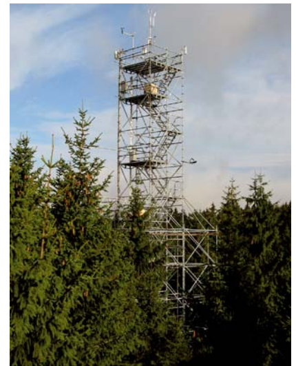
Abb. 2: Messturm Waldstein-Weidenbrunnen (30 m Höhe, Bestandeshöhe 19 m) der Universität Bayreuth im Fichtelgebirge mit der Kohlendioxidflussmessstation im Rahmen des FLUXNET-Programms.
