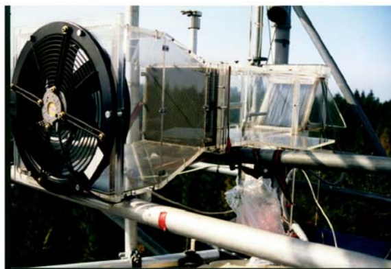
Abbildung 1: Der BCC-Nebelsammler auf dem Messturm Weidenbrunnen. Links das Ventilatorteil, in der Mitte das Zusatzmodul zur Sammlung interstitiellen Aerosols, rechts das Sammelteil mit der Schutzhaube (Wrzesinsky, 2004).
