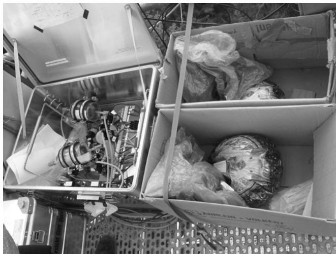
Abb. 2 Whole-air Relaxed Eddy Accumulation System während des Einsatzes im Experiment WALDATEM-2003. Als Zwischenreservoir für die Akkumulation der Luftproben dienen handelsübliche Mylar® Folienballons von Anagram International, Inc.
