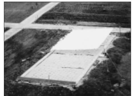
Abb. 6: Freigelände in Bielefeld – links: Tonnenexperiment; rechts: Sandbeet (20 x 6 x 1,5 m – L x B x T) mit ausgefahrenem Regendach.
